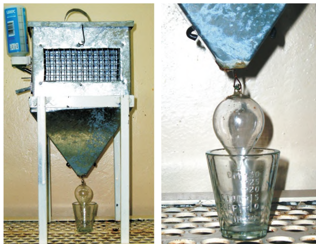
Рис. 1. Устройство индивидуальной клетки для сбора мочи и отделителя.
