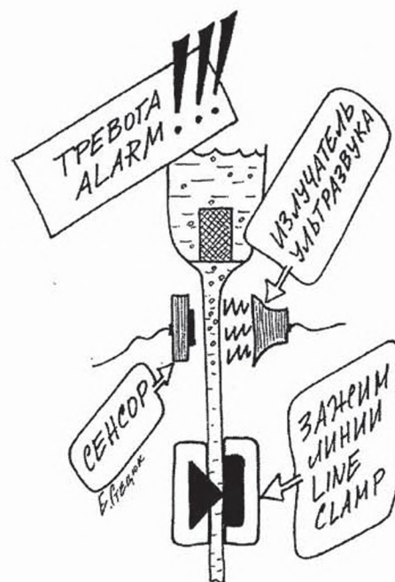
Рис. 12. Детектор воздуха и уровня с зажимом линии.
