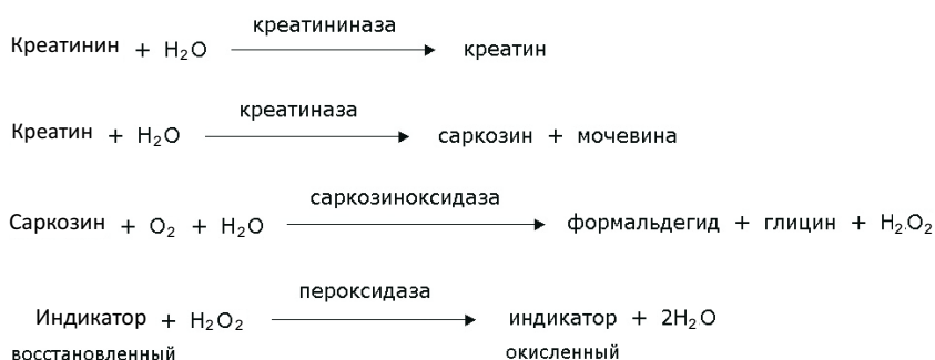
Рисунок 4. Схема связанных энзиматических реакций для количественного метода определения концентрации креатинина с ключевым ферментом креатиназой Figure 4. Scheme of consecutive enzymatic reactions for a quantitative method for creatinine concentration measuring with a key enzyme creatinase
