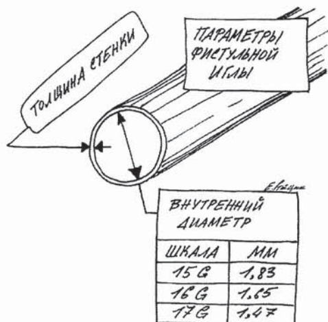
Рис. 2. Параметры фистульной иглы.
